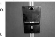
2 En la placa base se coloca entonces el teclado usando las almohadillas adhesivas. Es importante asegurarse de la sujeción de la pestaña que sobresale en la placa base se apoye en teclado, como se muestra. Como alternativa, puede pegar el teclado directamente sin la placa base. Llevar a cabo prueba de funcionamiento de la unidad con la puerta abierta. Para ello, introduzca varias veces un código de apertura secreto (p.ej. código pin, lector de huellas digitales...).
