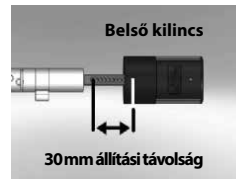
Sematikus ábrázolás A belső kilincs állítása
